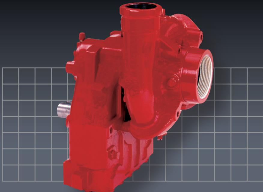
Die HALE CBP ist die kompakteste Feuerlöschkreiselpumpe, welche auch vom Nebenantrieb kleinerer Fahrgestelle angetrieben werden kann. Die Pumpe kann vollständig im Fahrgestellrahmen verbaut werden, so dass der Raum im Aufbau komplett für Einbauten und Beladung genutzt werden kann. Die Nennleistung nach EN 1028 beträgt 1000 l/min bei 10 bar. Die max. mögliche Fördermenge beträgt 1500 l/min, der max. mögliche Schließdruck beträgt 27 bar.
